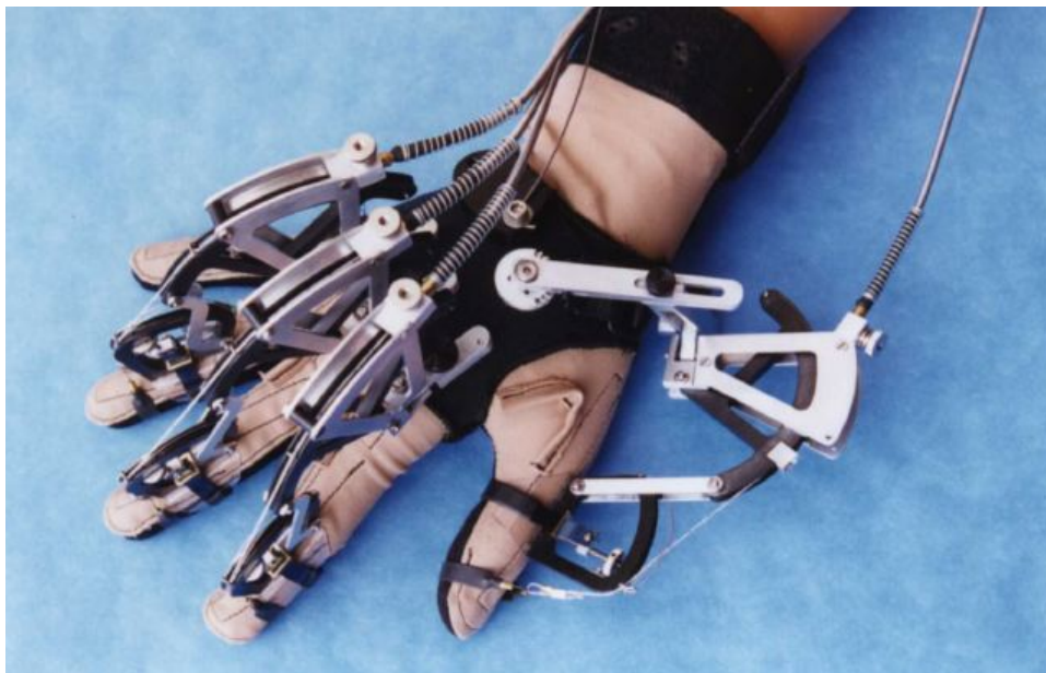
Luva háptica, desenvolvida pela EuroHaptics, simula o toque.
